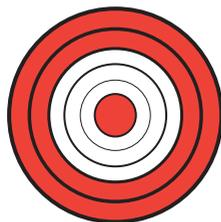
Pour vérifier le degré de magnétisme des petites pièces (visserie par exemple), il est recommandé de les placer dans les zones blanches de l'exemple ci-illustré. Le capteur placé au centre et les deux zones entre les 3 cercles extérieures (en rouge) ne détecteront pas le degré de magnétisme des petites pièces.
