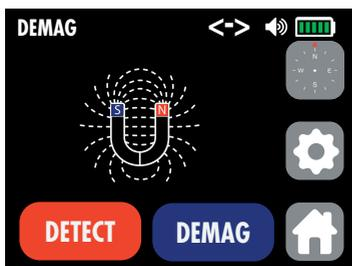
Affichage du sous-menu **DEMAG** en mode démagnétisation (on entend des beeps pendant le cycle. On verra aussi que les pôles **S** et **N** clignotent et se croisent pendant toute la durée du cycle)
